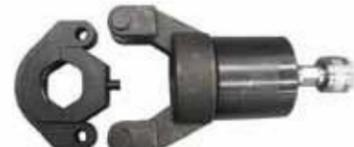
中型手動卡壓工具鉗座配置鉗口 (DN30~DN50)
