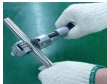
切割後管子不得失圓。切割後管口的端面應平整，並垂直于管軸線，其切斜 e 不得大於表內的規定；
